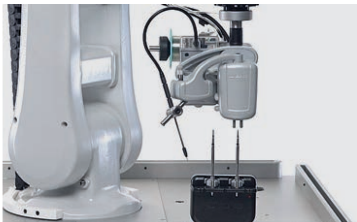
Система автоматической смены картридж-наконечников
