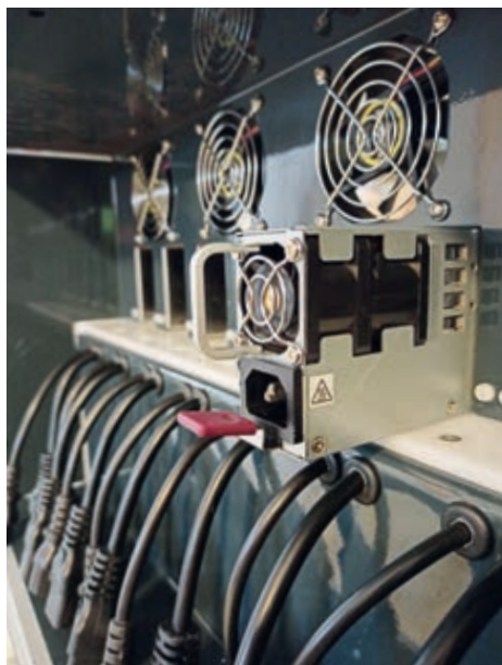
Тестируемый блок питания в одном из слотов стенда
