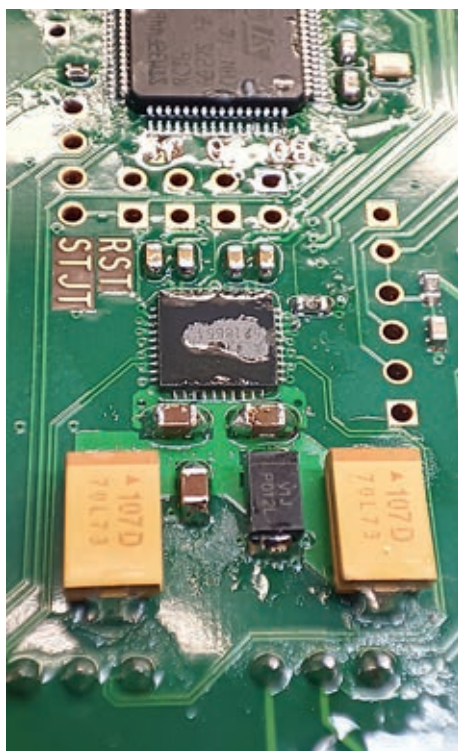
Флюс-гель «Солиус ФГ-018» после пайки при 380 °C
