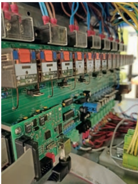
Модуль распределения входного напряжения на 8 слотов стенда
